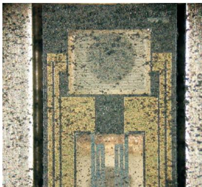
Соль и загрязнения могут привести к повреждению чувствительного элемента датчика расхода воздуха. Во всяком случае их наличие вызывает искажение результатов измерения, что, в свою очередь, может повлиять на работу системы рециркуляции отработанных газов.
